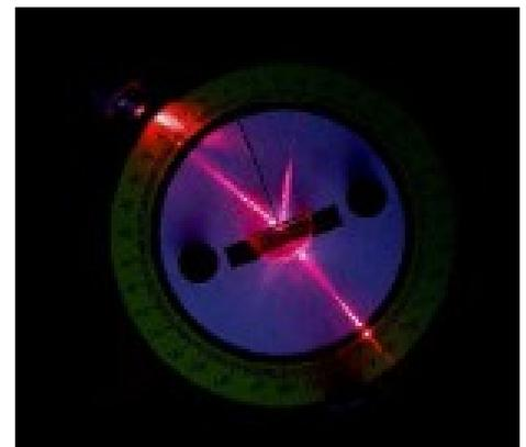
Рис. 5. Демонстрация закона Снеллиуса – Декарта с помощью прибора Гартля.
