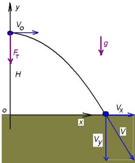
Рассмотрим движение тела, брошенного с начальной горизонтальной скоростью  $V_0$ . Если не учитывать сопротивления воздуха, на такое тело действует только сила тяжести  $F_T = mg$  (см. рисунок). Уравнение движения тела получается из рассмотрения второго закона Ньютона:
