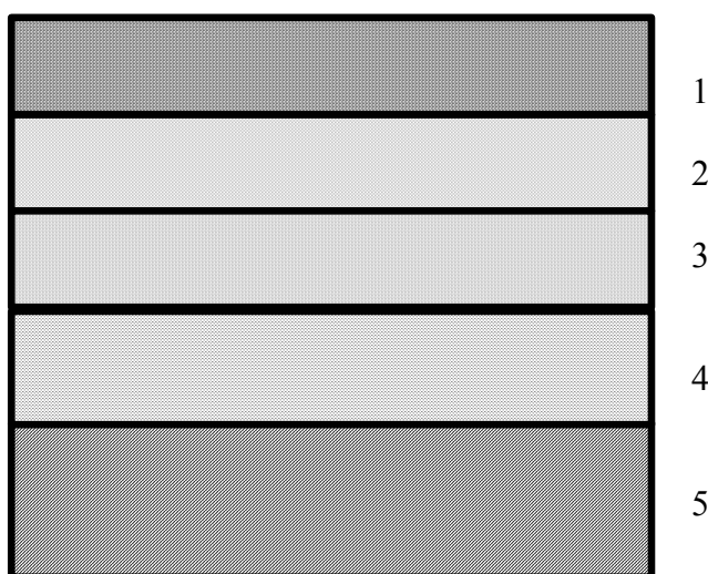
Рисунок 14 - Строение цветного фотоматериала: 1 – 3 эмульсионные светочувствительные слои, 4 – баритовый слой, 5 – бумажная подложка
