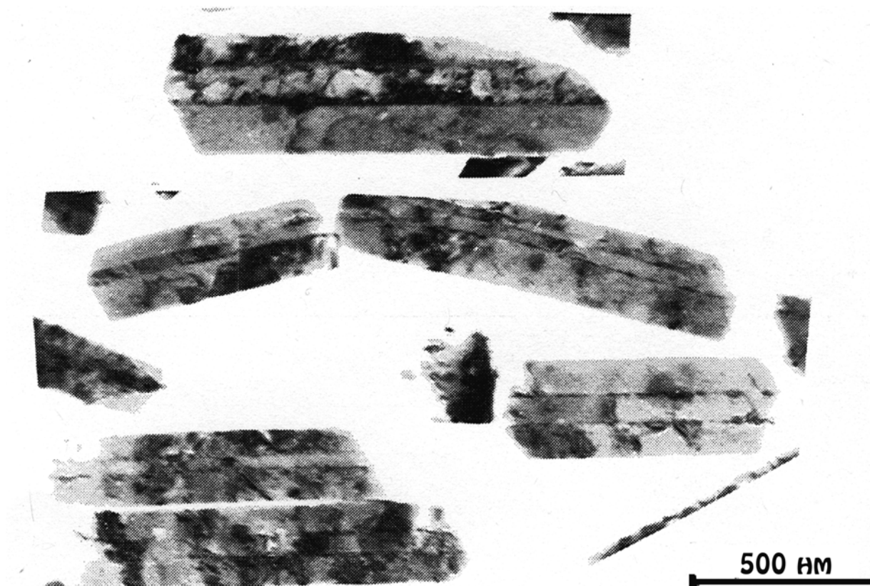
Рис. 2.18. Электронная микрофотография поперечного сечения слоя содержащего плоские кристаллы
