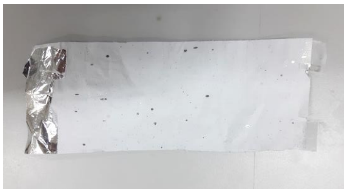
Рис. 3. Результат осаждения нановолокон ПВС на лист фольги
