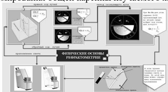
Рисунок 9. Карта визуализации метода определения показателя преломления с помощью рефрактометра
