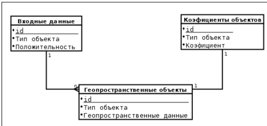
Рисунок 1. Реляционная модель базы данных
