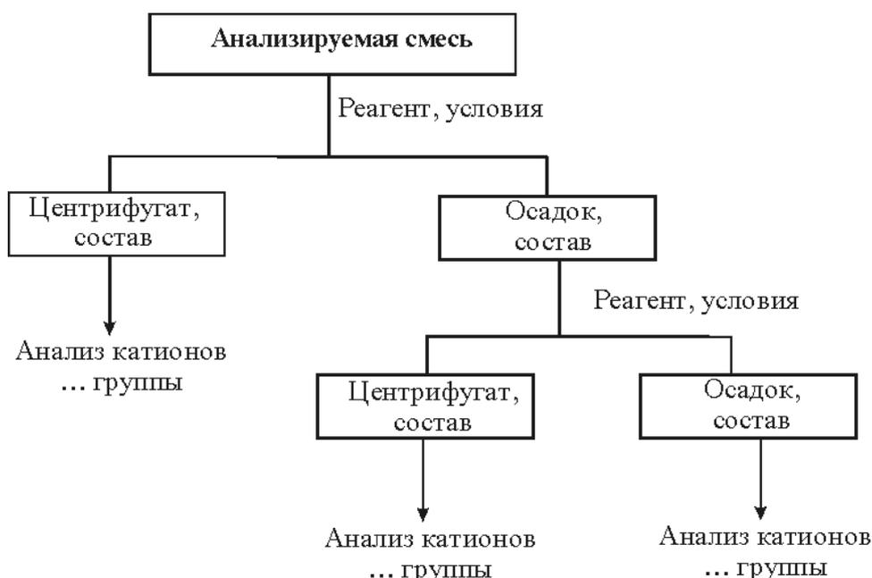
Рис. 1. Схема анализа контрольной задачи смеси катионов.
