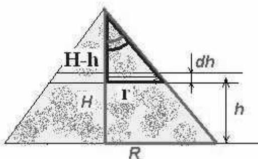
Рассмотрим физическую модель решения этой задачи. В данном случае работа затрачивается при поднятии песка на некоторую высоту. Работу можно вычислить по формуле  $A=mgh$ , где  $m$  – масса песка,  $g$  – ускорение свободного падения,  $h$  –
