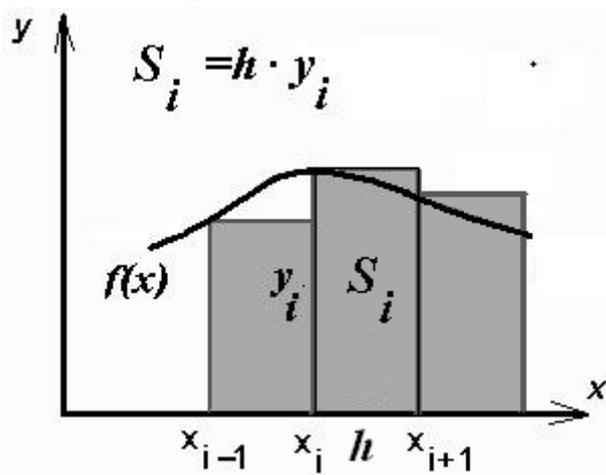
В методе прямоугольников криволинейную трапецию, ограниченную функцией  $f(x)$  на каждом отрезке  $[x_i, x_{i+1}]$  заменяют на прямоугольник. В **методе прямоугольников слева** высота прямоугольника выбирается равной  $y_i = f(x_i)$  – значение функции в крайней левой точке отрезка  $[x_i, x_{i+1}]$
